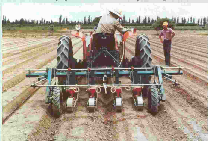
Equipo operando. Vista posterior: sembradores y barra de aplicación de herbicida preemergente.
