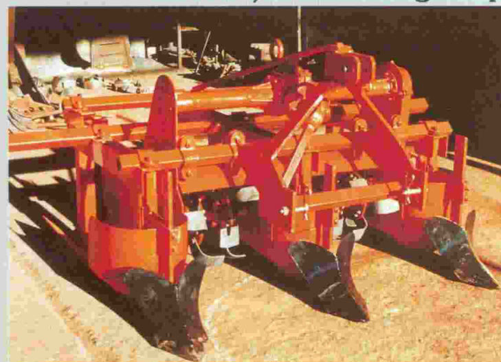
Equipo de siembra INTA-R N° 2. Vista anterior: formador de camas con rotocultor y surcadores. Potencia de equipamiento: 45 a 55 HP.
