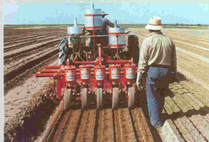
Equipo operando. Vista posterior: mullido del suelo, formado de cama, fertilización y siembra (5 líneas de siembra sobre cama de 1,60 m de ancho en su base inferior)
