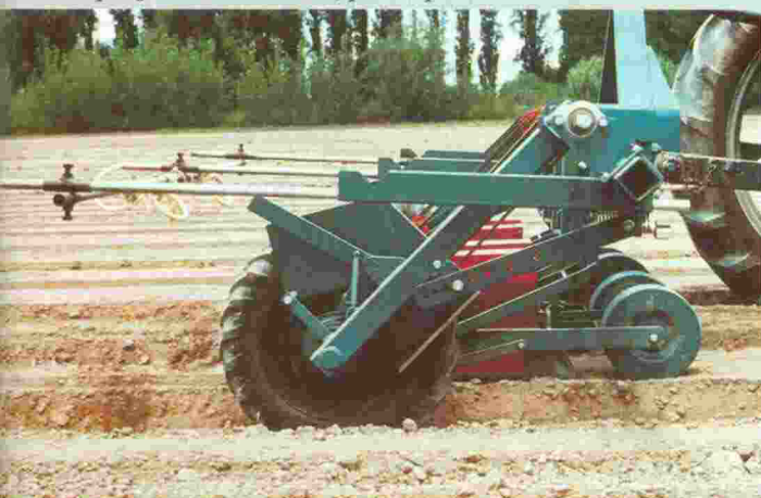
Equipo operando. Vista lateral: sembradores y barra de aplicación de herbicida preemergente.
