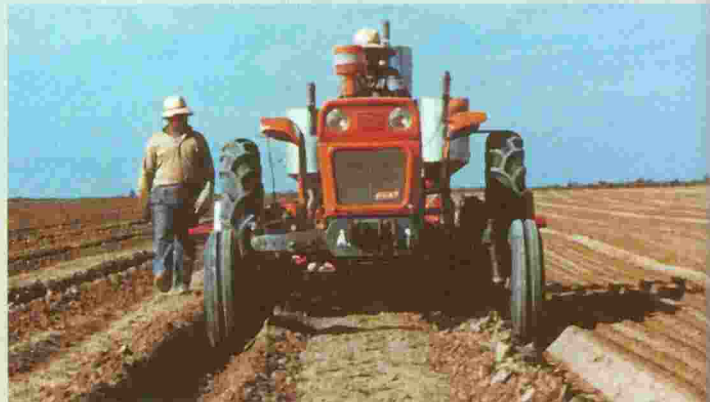
Equipo INTA R-2 operando. Vista anterior. Potencia de equipamiento: 60 a 70 HP.
