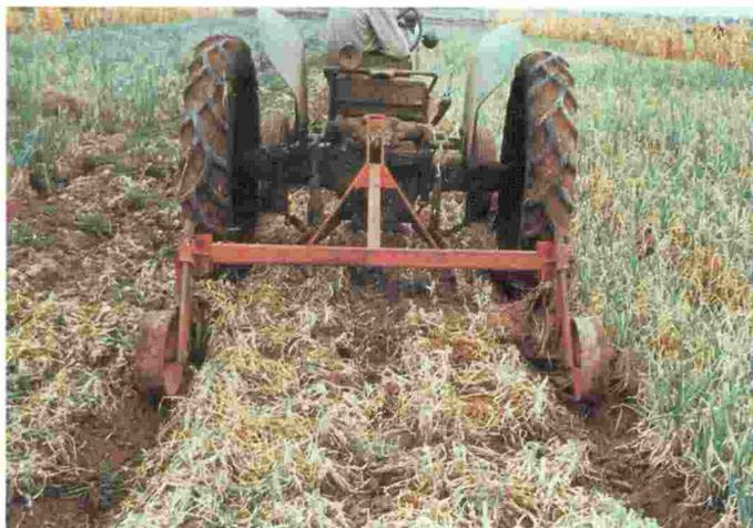
*Corte de suelo ("under cutting") mediante cuchilla horizontal continua y registro de profundidad de corte*
